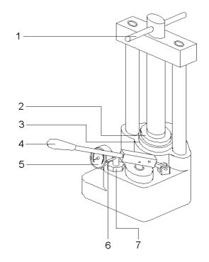
POS. 1:SCREW LEVERPOS. 2:UPPER PLATEPOS. 3:LOWER PLATEPOS. 4:PUMP LEVERPOS. 5:PRESSURE GAUGEPOS. 6:COCK LEVERPOS. 7:COCK SCREW
