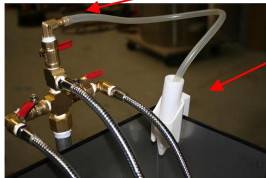
7. Fixer le tube de vidange au robinet à l'intérieur de l'échaudeuse.
