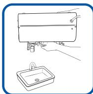
Dé vuelta la unidad para drenar toda el agua del tanque. Agregue agua limpia y repita el proceso si es necesario, en caso de que todavía haya sedimentos.
