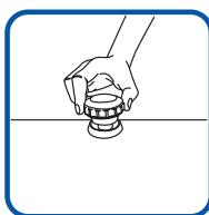
Abra un poco la tapa de seguridad de llenado para que se libere el resto del vapor.
