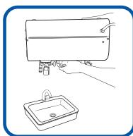
Retourner l'unité pour vider toute l'eau présente dans le réservoir. Ajouter de l'eau propre et recommencer si nécessaire pour retirer tous les sédiments.
