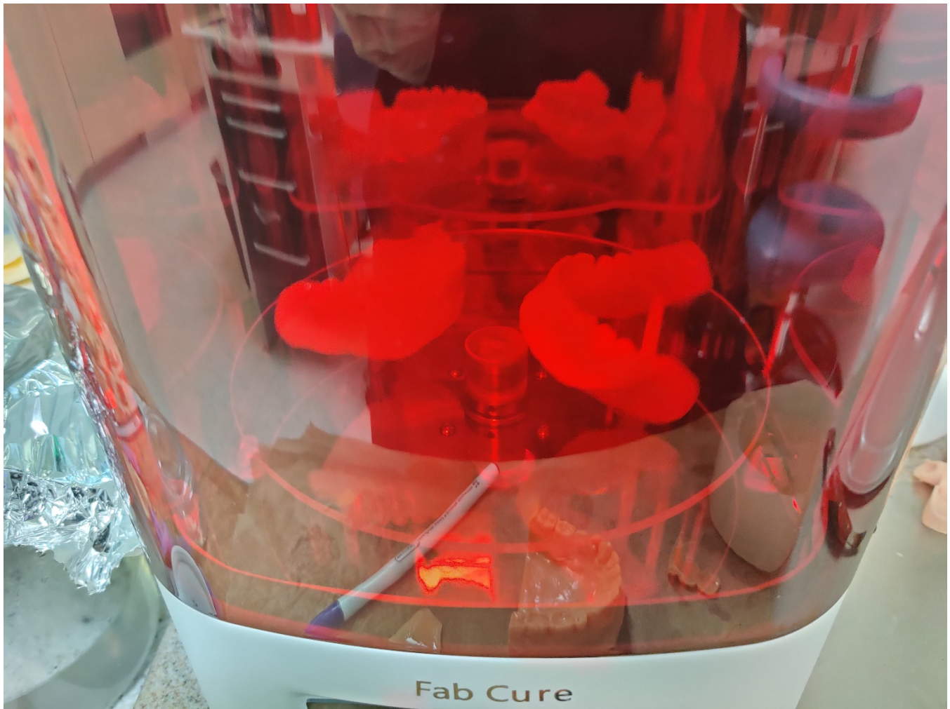
Figure 40 Post-durcissement final des prothèses effectué dans l'unité Fab Cure LED
