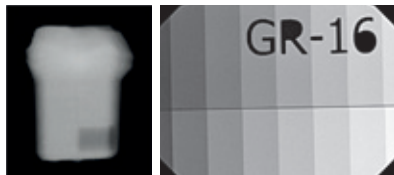
Abb./Fig. 19: Röntgensichtbarkeit printodent ® GR-16 Xray im Vergleich zu einer Aluminiumtreppe (ISO 4049)./ Radiopacity of printodent ® GR-16 Xray in comparison to aluminum stairs (ISO 4049).
