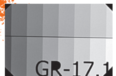
Abb. / Fig. 21: Röntgensichtbarkeit printo ® GR-17.1 temporary It im Vergleich zu einer Aluminiumtreppe (ISO 4049).
